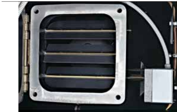
设定空气量的伺服马达及风挡示例
