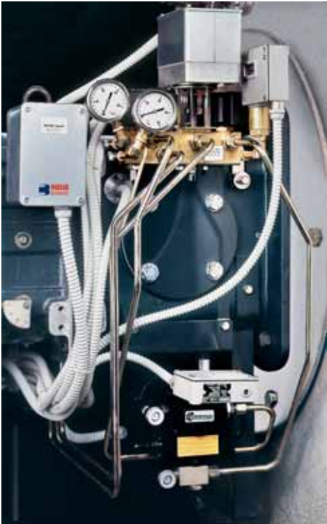
MB 4 LE 型燃烧器液压回路示例
